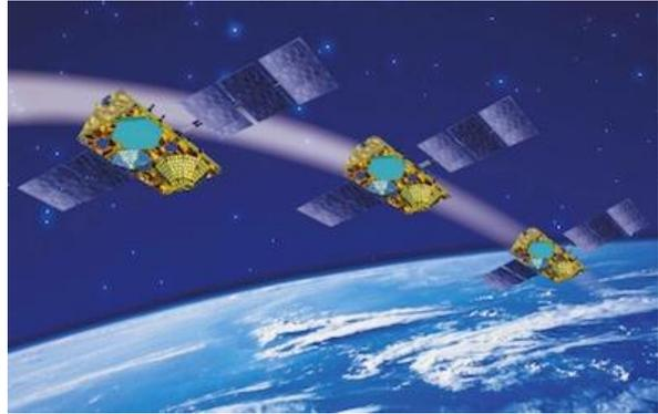
Los mensajes se transmiten desde SmartOne a través de la red satelital Globalstar utilizando una conexión de enlace ascendente (transmisión de datos unidireccional) y se reciben en una estación terrestre Globalstar. Luego, los mensajes se envían a través de un servidor HTTP o FTP a Internet y el VAR o la aplicación de back office del cliente final los recibe y los convierte en datos procesables.
