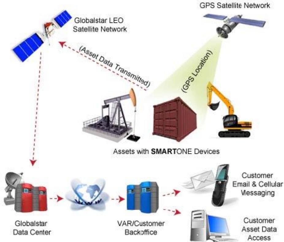
SmartOne tiene la capacidad única de verificar sus coordenadas GPS a una velocidad programable mientras está dentro del Área de Cambio de Ubicación sin enviar un mensaje a través de la Red de Satélites Globalstar.
