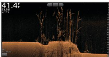
Los transductores tradicionales emiten un haz cónico. La tecnología de la sonda de exploración Garmin ClearVü emite dos haces estrechos similares a la forma del haz de una fotocopiadora. Estos haces ofrecen una imagen más clara, similar a una fotografía, de lo que hay debajo de la embarcación.
